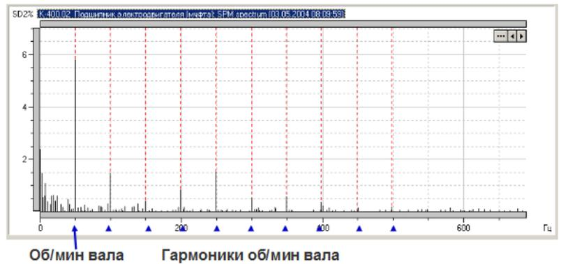
Подшипник роторного компрессора. Пунктиром указаны линии, соответствующие повышенной нагрузке на подшипник от 4-х заходного ротора.
